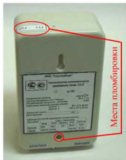
Фото 2 - Схема пломбировки сигнализатора от несанкционированного доступа и обозначение мест для нанесения наклеек с клеймом поверителя
