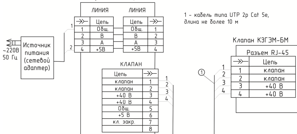
Рис. 2. Схема электрических соединений системы СГК-1-х-Б с бытовым электромагнитным клапаном КЗГЭМ-БМ.
